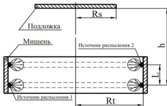
Рисунок 1 – Геометрическая схема модели системы МРС для нанесения на крупноформатные подложки методом реактивного магнетронного распыления ( R_s – радиус подложки, R_t – радиус мишени, L – расстояние между кольцами распыления, h – расстояние между нижним кольцом распыления и подложкой)
