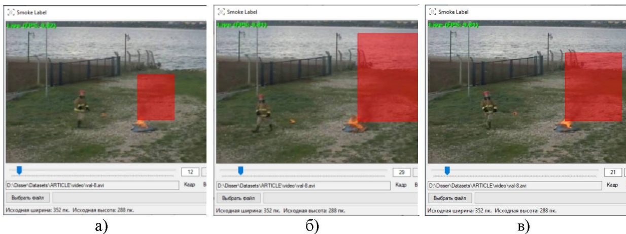
Рисунок 3. Аннотирование объекта дыма в приложении «Smoke Label»: а) построение рамки для кадра №12; б) построение рамки для кадра №29; в) интерполированная рамка в кадре №21
