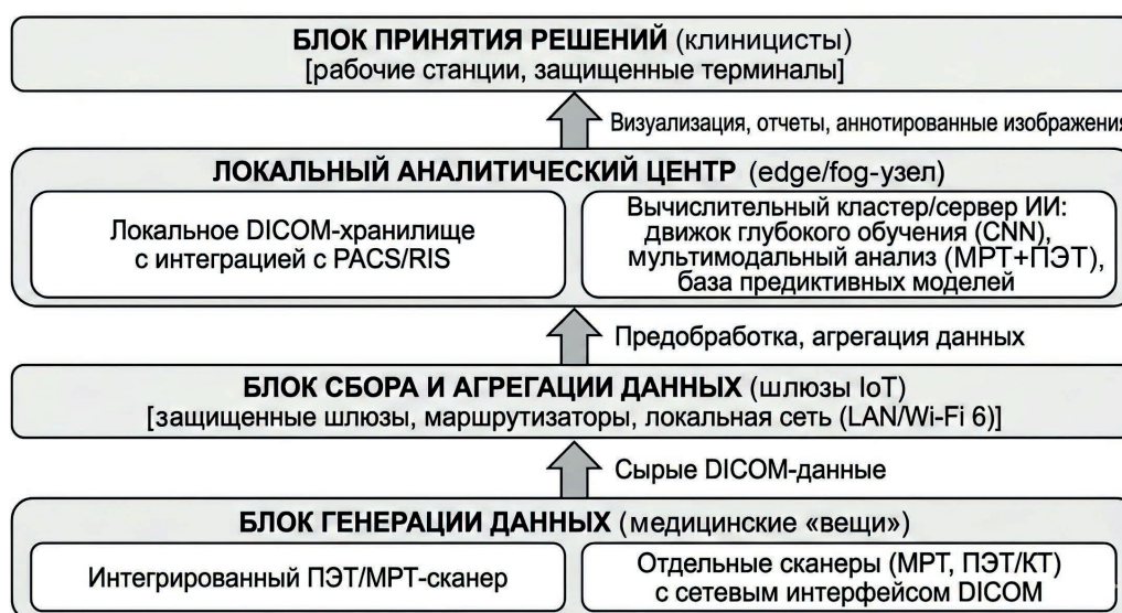
Рис. 1. Структура локальной системы интернета медицинских вещей для анализа медицинских изображений
