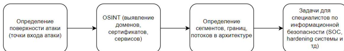
Рисунок 1 – Последовательность выявления поверхности атак с помощью OSINT в корпоративной инфокоммуникационной системе
