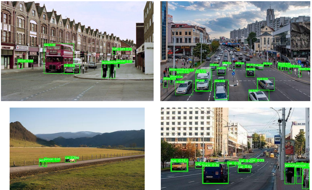
Рисунок 6 – Результат детектирования объектов с использованием SSD (300)
