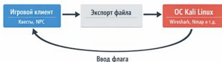
Рисунок 1 – Схема взаимодействия игрового клиента и физической операционной системы обучающегося
