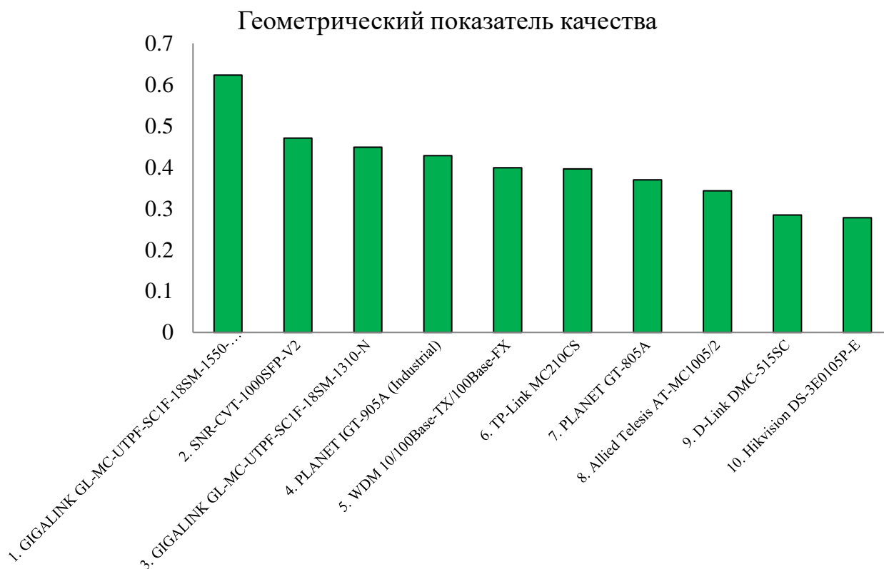
Рисунок 2 – Распределение комплексных геометрических показателей качества медиаконвертеров
