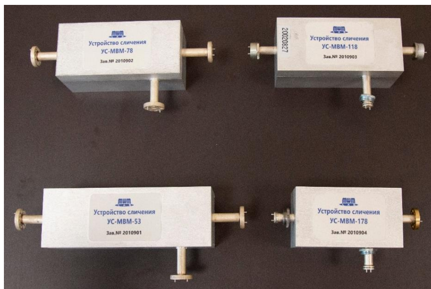
Рисунок 1 – Внешний вид устройств сличения УС-MBM-53, УС-MBM-78, УС-MBM-118, УС-MBM-178
