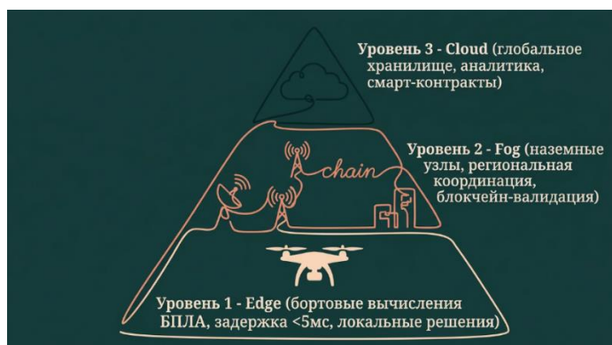
Рисунок 1 – Многоуровневая архитектура Edge–Fog–Cloud
