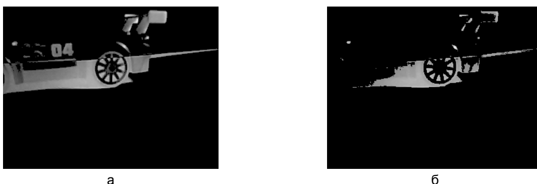
Рисунок 2 – Пороговая фильтрация кадра классическим алгоритмом (а) и с бисекцией (б)
