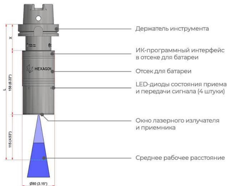
Рисунок 2 – Компоновка разрабатываемого лазерного модуля
