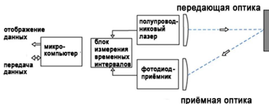
Рисунок 1 – Функциональная схема лазерного 3D-сканера для контроля качества продукции
