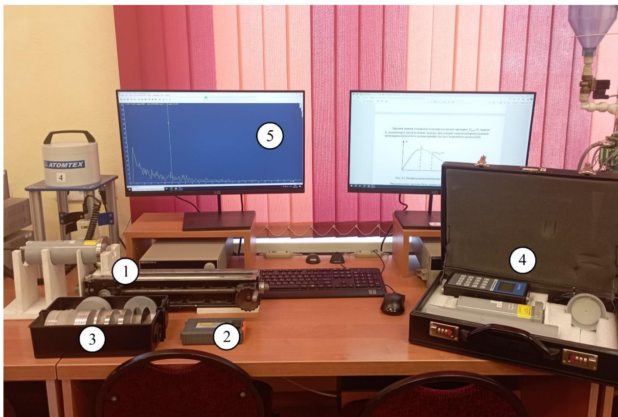
Рис. 1. Общий вид лабораторного стенда для измерения ионизирующего излучения на основе системы линейного перемещения
