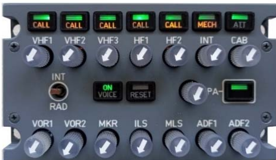
Рис. 1 Внешний вид субпанели аудиосвязи
