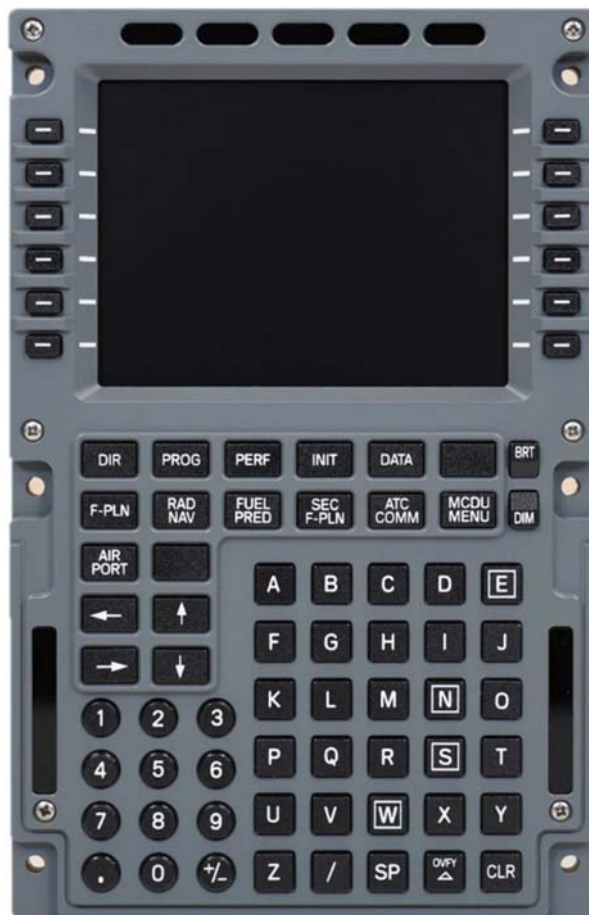
Рис. 3 Внешний вид субпанели MCDU
