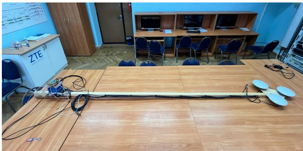
Рисунок 5 – Конструкция аппаратной части аппаратно-программного модуля измерения полного электронного содержания в ионосфере
