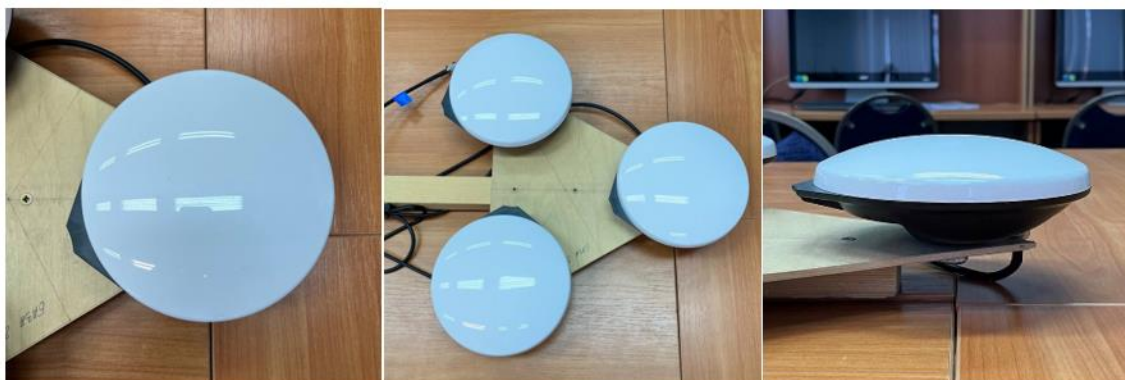
Рисунок 2 – Антенна со встроенным МШУ (вид сверху, сбоку)
