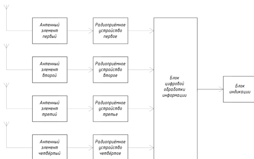
Рисунок 1 – Структурная схема радиопеленгатора
