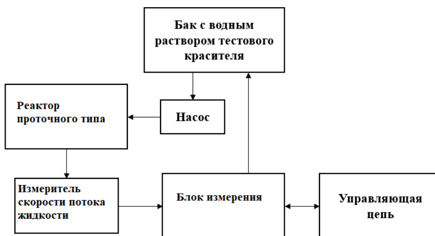
Рисунок 1 – Блок-схема установки фотокаталитической очистки воды в проточном реакторе
