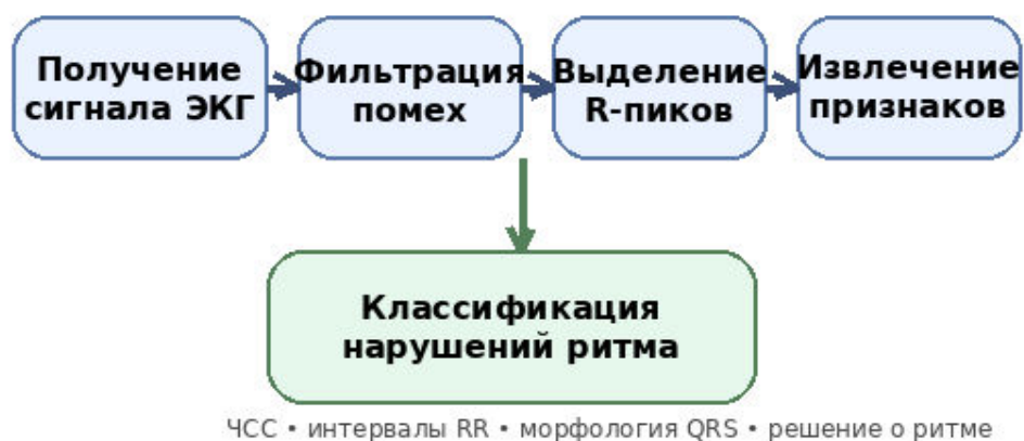
Рисунок 2 – Структурная схема алгоритма автоматизированного анализа ЭКГ
