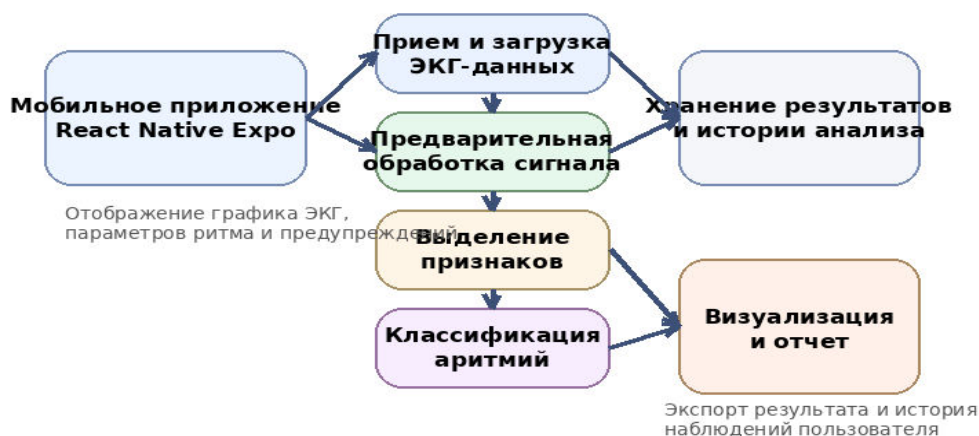
Рисунок 4 – Архитектура разработанного программного обеспечения анализа электрокардиограмм
