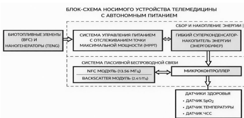
Рисунок 2 – Блок-схема усовершенствованной телемедицинской патч-системы с гибридным энергосбором
