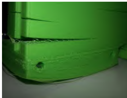
Рисунок 2 – Расслоение вдоль слоев
