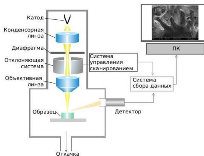
Рисунок 1 – Принципиальная схема СЭМ
