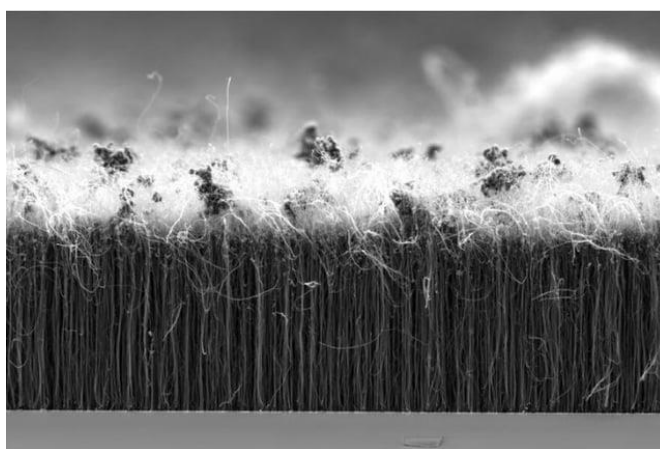
Рисунок 2 – СЭМ-изображение вертикально выровненных массивов углеродных нанотрубок. Черные пятна сверху - аморфный углерод
