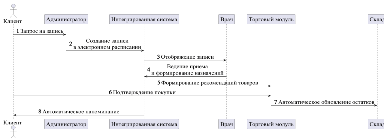
Рисунок 2 – Диаграмма последовательности после внедрения единой автоматизированной системы
