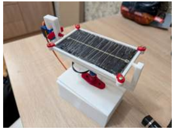
Рис. 1 – Экспериментальный образец системы наведения солнечной панели на базе Arduino Nano
