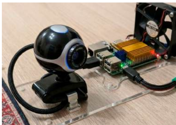
Рис. 2 – Аппаратная реализация узла с системой охлаждения
