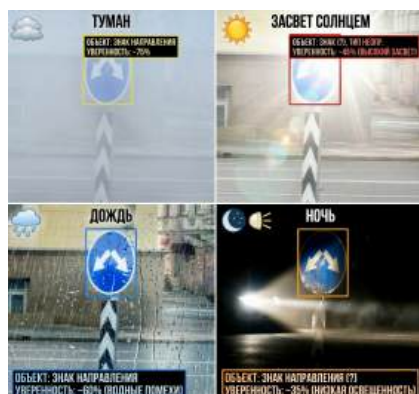
Рис. 2 – Тестирование распознавания дорожных знаков в условиях оптических искажений
