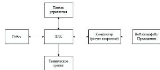
Рис. 1 – Структура системы управления роботом-палетоукладчиком
