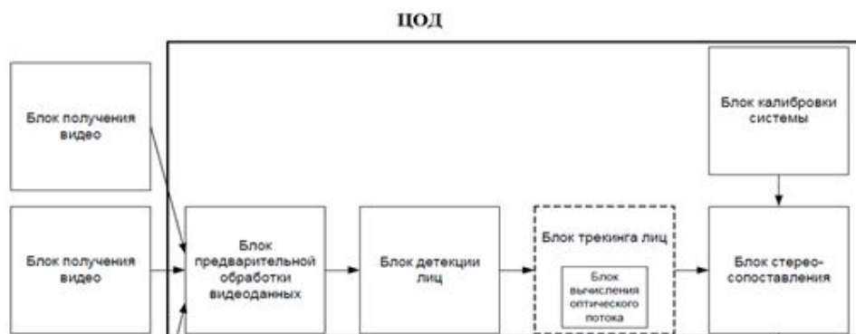
Рис. 2. Архитектура системы видеоаналитики при передаче видеопотока об объектах интереса с дрона в центр обработки данных
