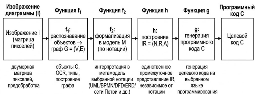
Рис. 2. Модель преобразования «изображение–код»
