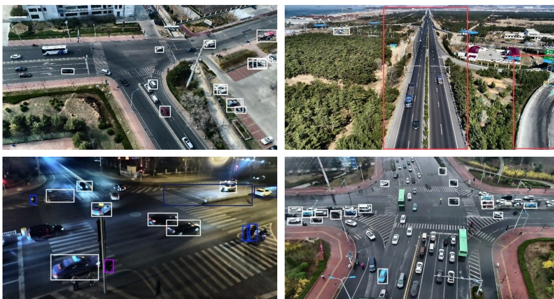
Рис. 4. Детекция объектов моделью YOLOv8n с предобработкой методами CLAHE и гамма-коррекции
