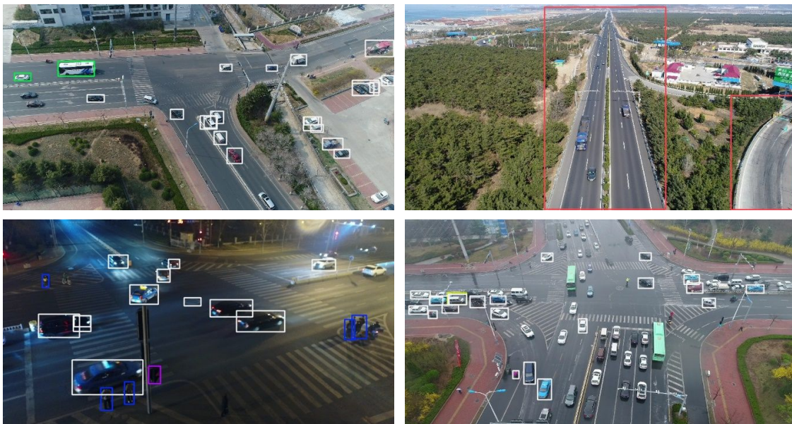
Рис. 2. Детекция объектов моделью YOLOv8n без предобработки
