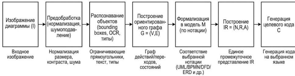
Рис. 3. Схема алгоритма обработки изображения и генерации кода
