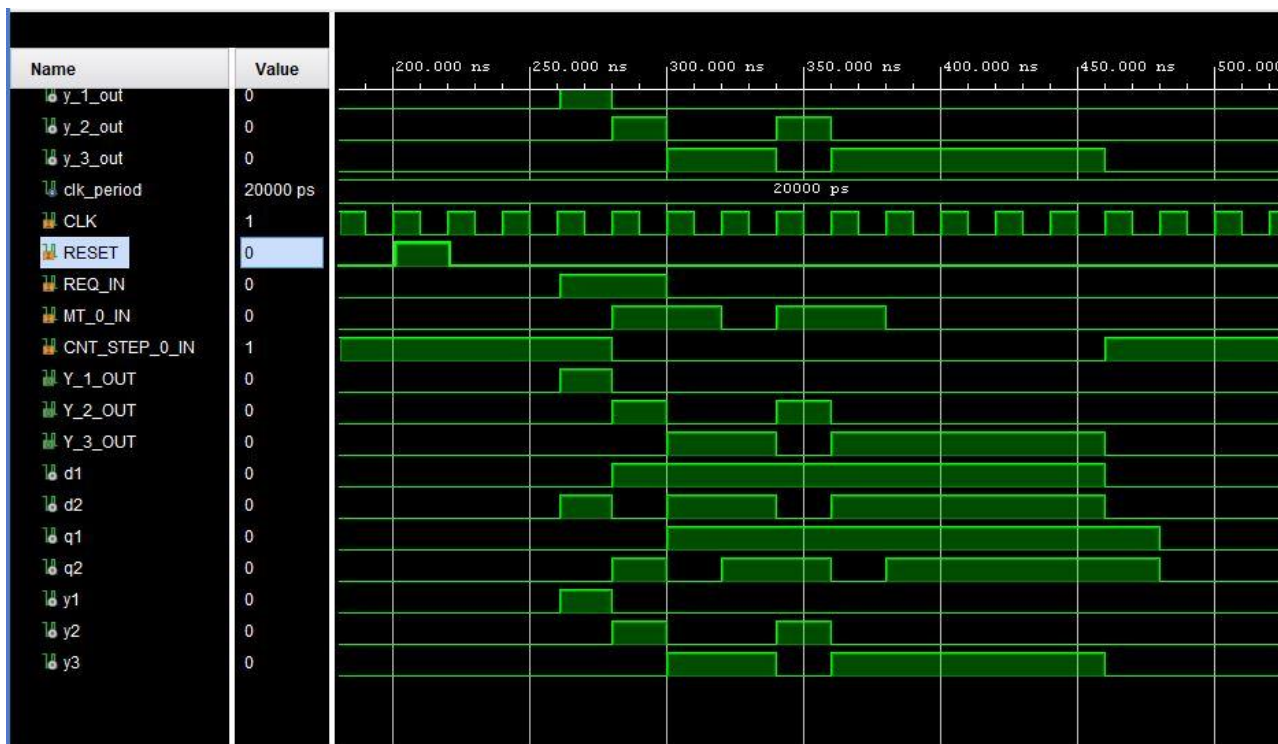
Рис. 4.1. Временная диаграмма функционального моделирования управляющей части устройства умножения
