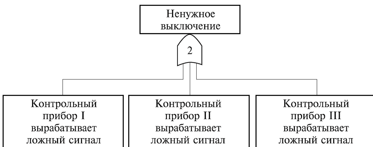
Рисунок 4.8 – Пример применения логического знака «два из трех»
