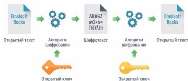
Рис. 2. Схема асимметричного алгоритма шифрования
