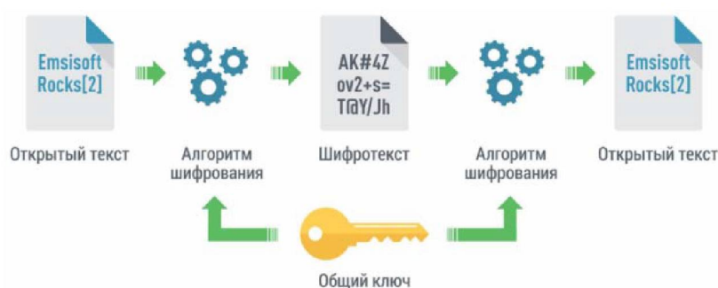
Рис. 1. Схема симметричного алгоритма шифрования
