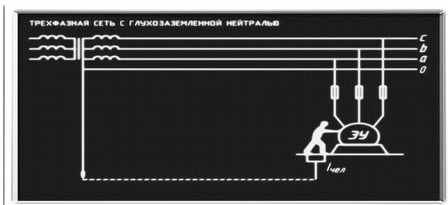
Рисунок 5.10 – Схема электрической цепи после включения тумблера «Нейтраль трансформатора r_0 »
