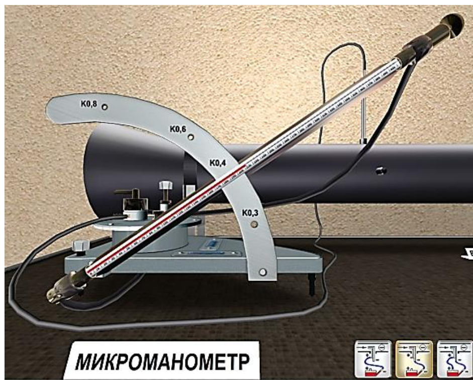
Рисунок 3.15 – Внешний вид имитационной модели с выбранной схемой подключения микроманометра для измерения перепада статического давления
