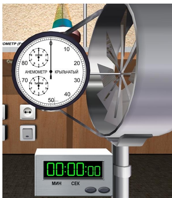
Рисунок 1.12 – Конструкция крыльчатого анемометра АСО-3
