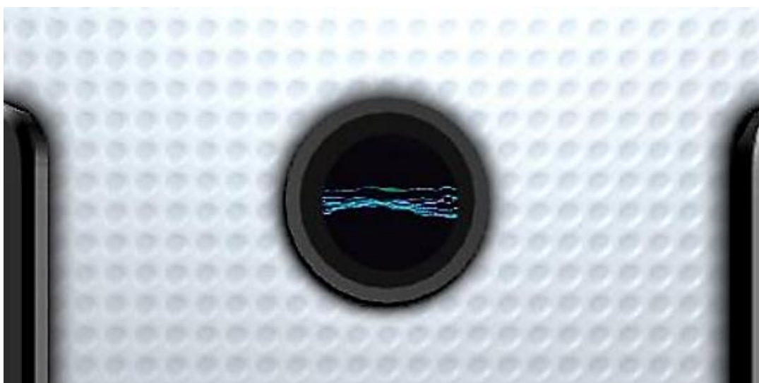
Рисунок 4.10 – Образование искрового разряда в разрядной камере
