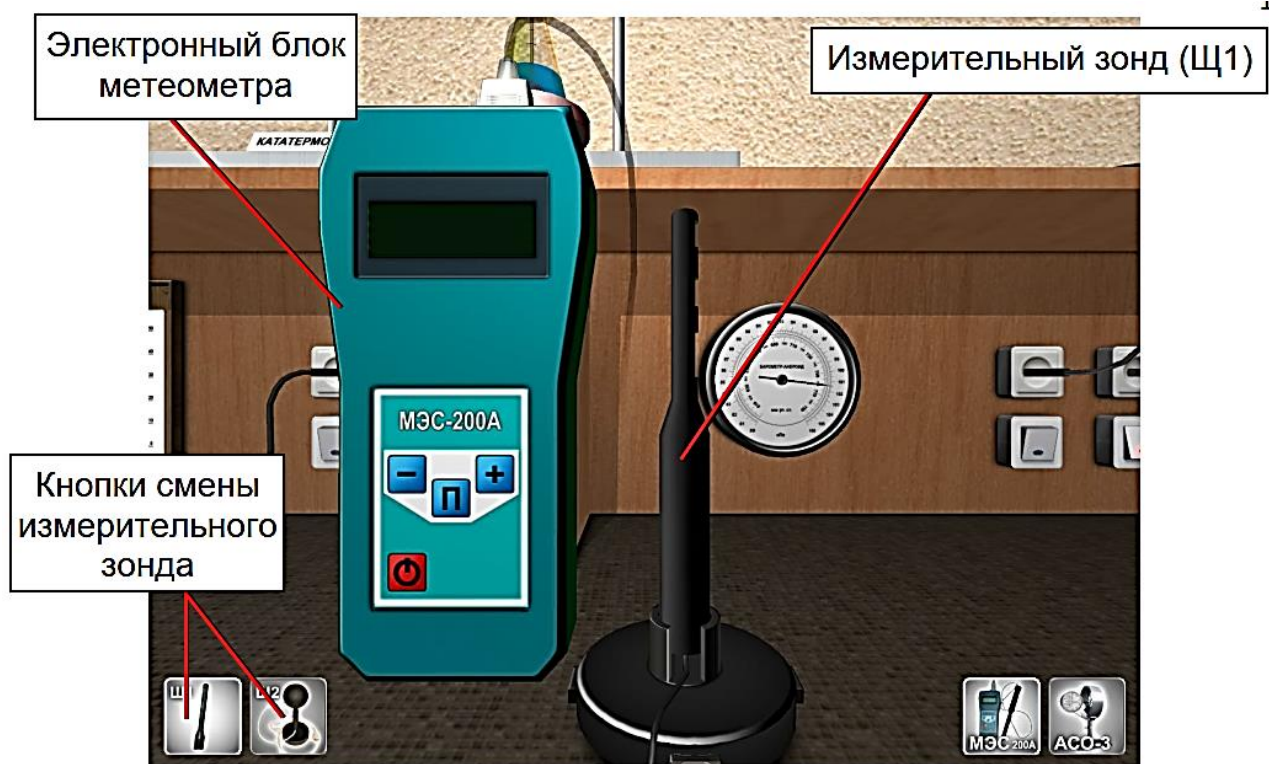
Рисунок 1.16 – Режим работы с метеометром МЭС-200А (измерительный щуп Щ1)
