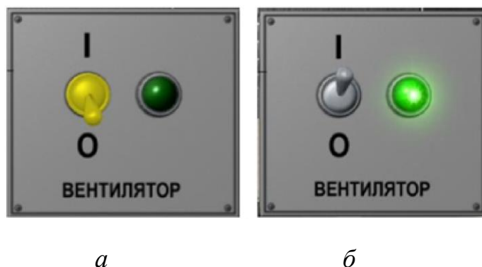
Рисунок 3.6 – Блок управления приводом вентилятора в выключенном ( а ) и включенном ( б ) состояниях
