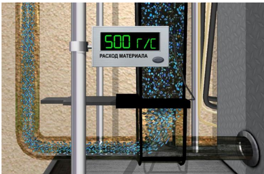
Рисунок 4.9 – Циркуляция материала в системе пневмотранспорта
