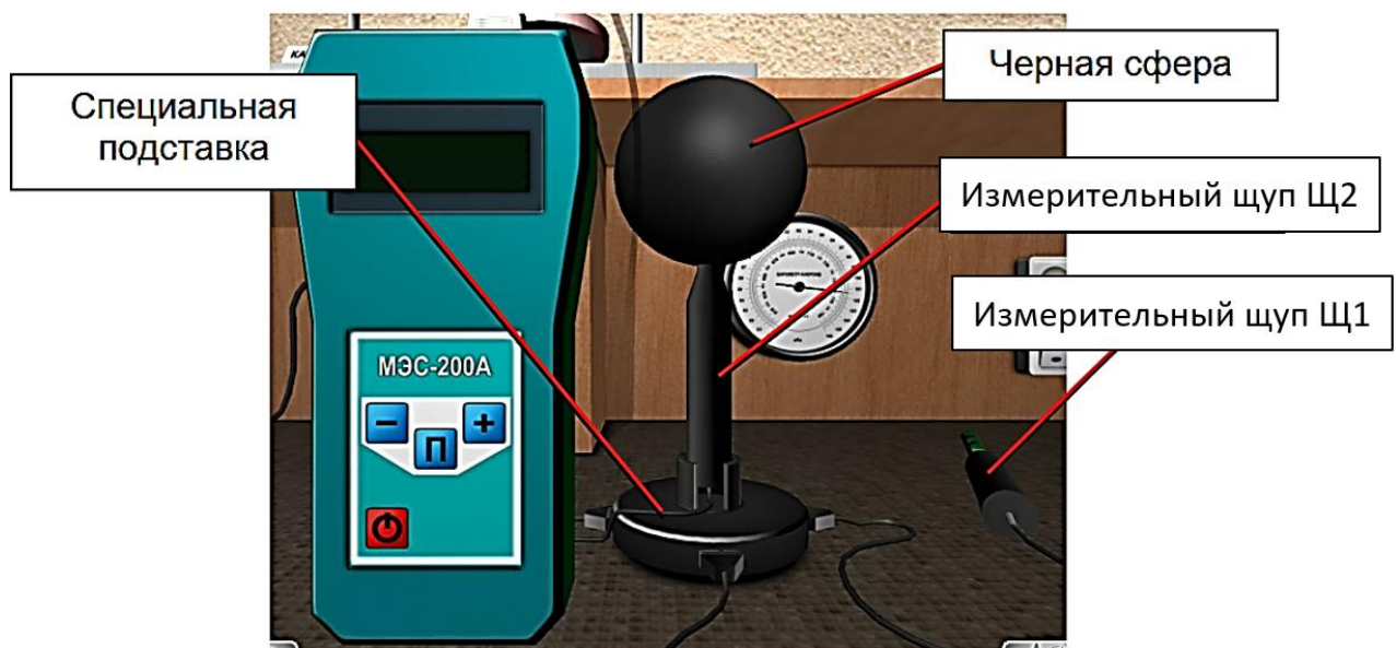
Рисунок 1.17 – Режим работы с метеометром МЭС-200А (измерительный щуп Щ2)
