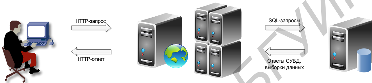
Рис. 1. Принцип обработки запросов web-приложением
