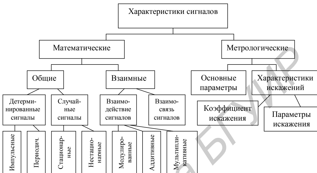
Рисунок 4.2 – Классификация характеристик измерительных радиотехнических сигналов
