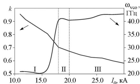
Рис. 2. Зависимости коэффициента  $k$  и частоты основной гармоники  $\omega_{VCO}$  в спектре токовых осцилляций от тока пучка  $I_0$  при фиксированном магнитном поле  $B_0 = 1.2$  Тл. Римские цифры обозначают области с качественно различной динамикой
