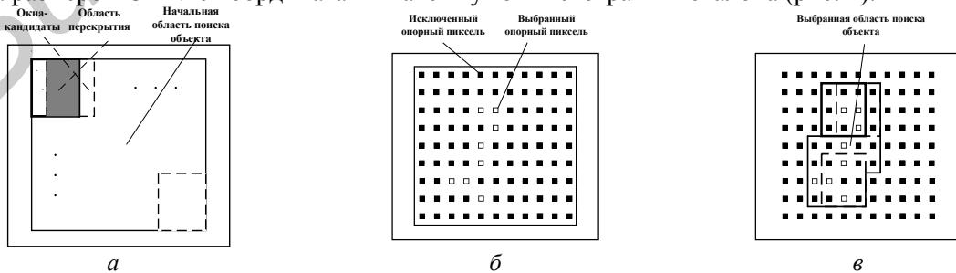
Рис. 4. Изображения областей поиска объекта при селективной гистограммной обработке окон-кандидатов: *α* – начальная область поиска объекта; *β* – обработанная сетка опорных пикселей; *γ* – область поиска объекта на основе выбранных опорных пикселов
