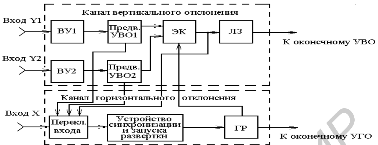
Рисунок 4.2 – Структурная схема входных цепей двухканального осциллографа
