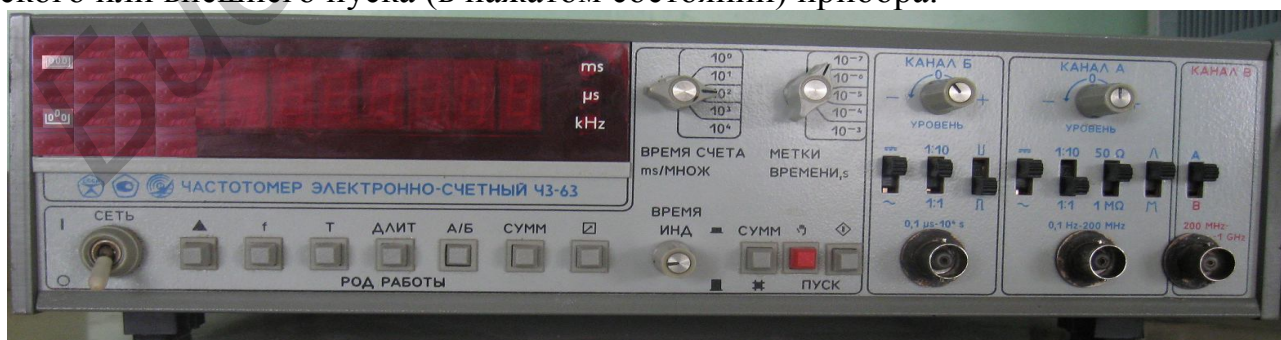
Рисунок Е.2 – Внешний вид частотомера электронно-счетного ЧЗ-63
