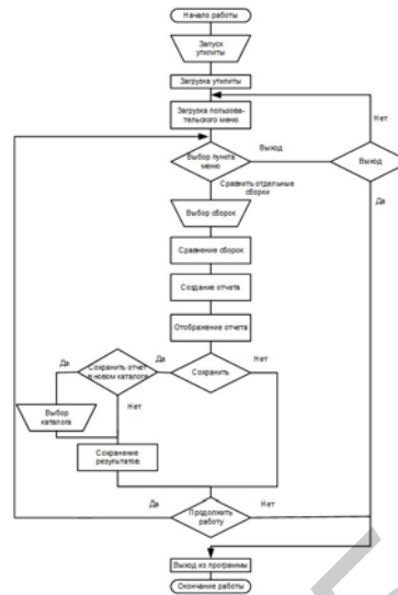
Рисунок 1 – Алгоритм работы пользователя при сравнении отдельных сборок
