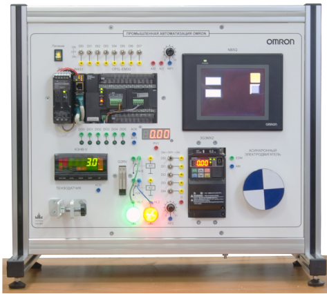
Рис. 1 – Внешний вид лабораторного стенда для изучения современных средств автоматизации
