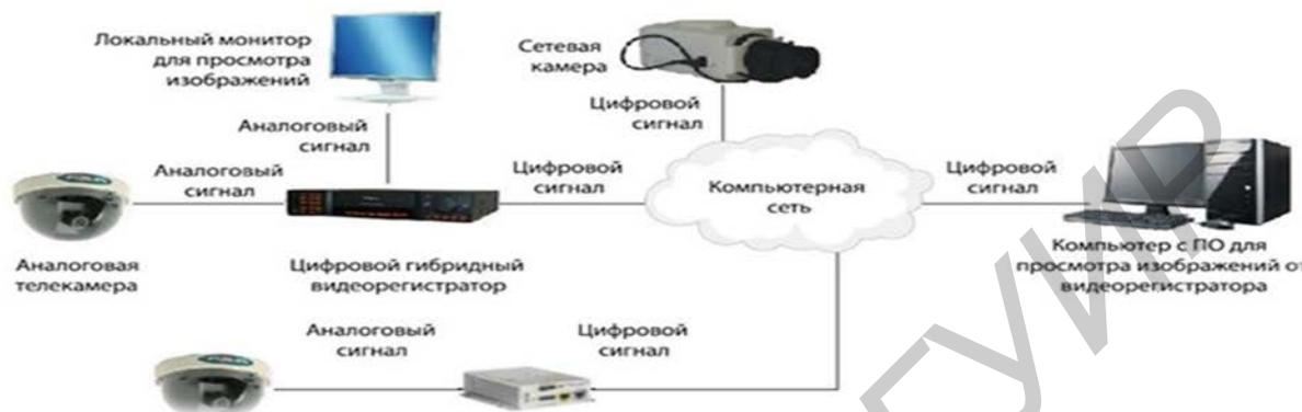
Рисунок 1 – Структурная схема видеонаблюдения
