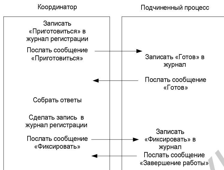
Рис. 3.7. Двухфазный протокол фиксации транзакции
