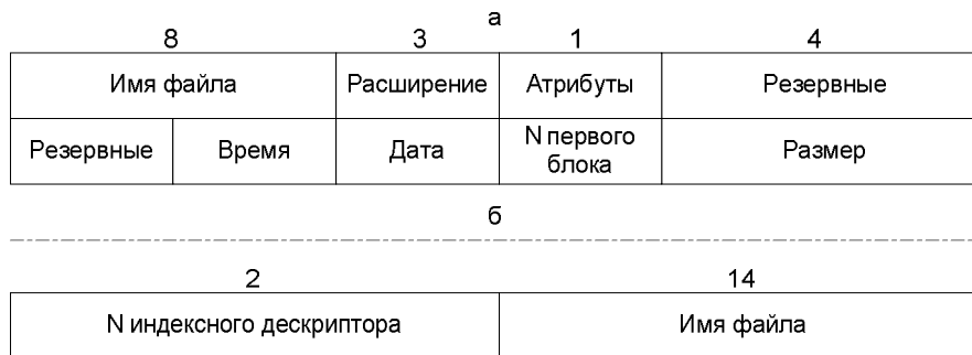
Рис. 2.19. Структура каталогов: а — структура записи каталога MS-DOS (32 байта); б — структура записи каталога ОС UNIX
