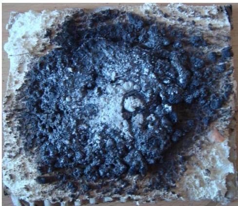
Рис. 2. Внешний вид образца конструкции электромагнитного экрана после его термообработки открытым пламенем
